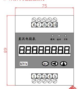
外型尺寸: 75mm\*89mm\*74mm(长×宽×深) 安装方式: 35mm 标准**导轨安装 ※**
