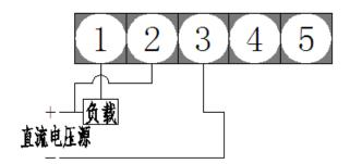
注意: 电流输入端(分流器)须接在负载的负极端,若需要接在正极端,订货时需特殊说明。
